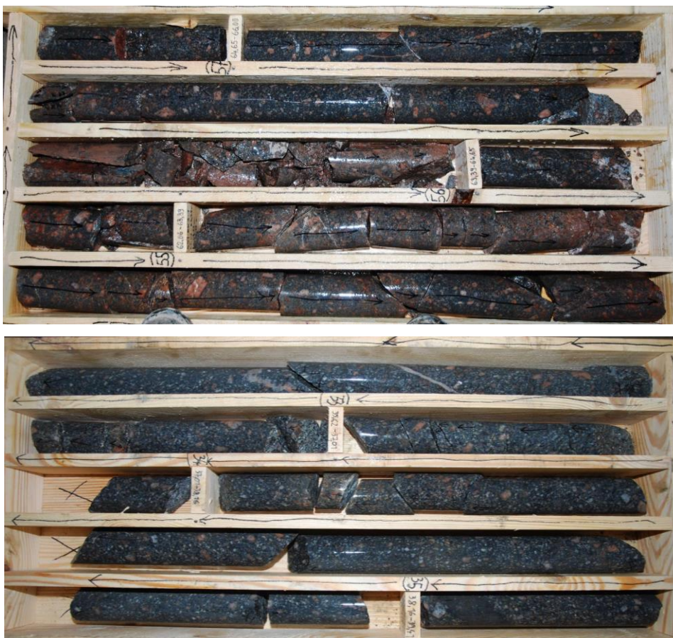
2. ábra. Változatos repedezettségi állapotokat mutató magládafotók
